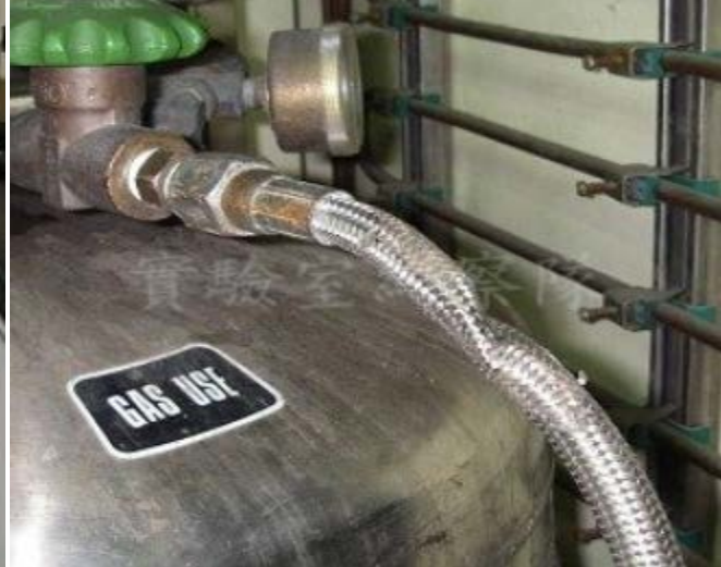
▲管子已經被打壞了，應該立即更換，否則漏氣時可能造成缺氧，很危險。
