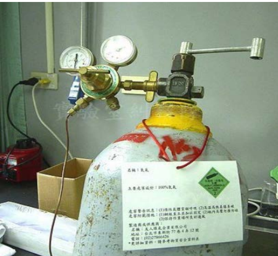
▲氣體標示這樣掛是不對的，因為法規是規定要貼在「容器」上面。如果暫時不使用，扳手也應該取下。
