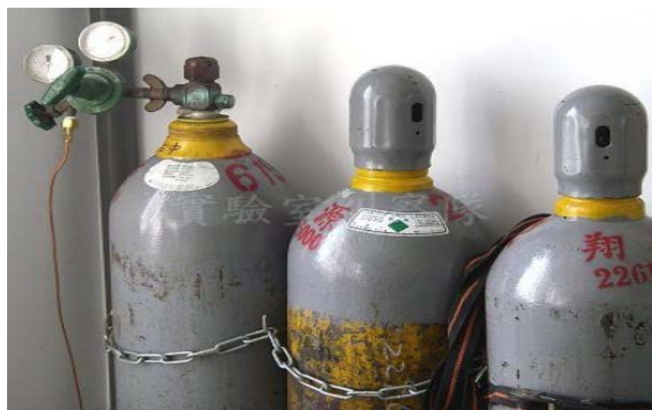
▲不用的鋼瓶要像這樣加上鋼瓶帽，以免不慎撞擊時遭到損毀而漏氣。
